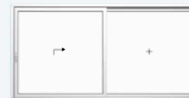
Schema A, DIN links 1 Hebe-Schiebeflügel, 1 Festverglasung
