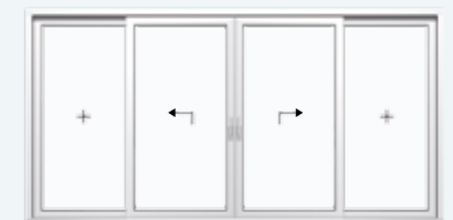
Schema C 2 Hebe-Schiebeflügel, 2 Festverglasungen
